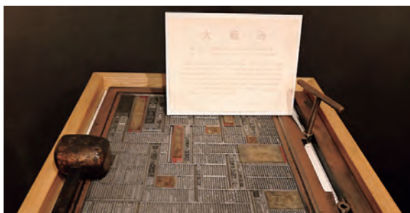
鉛活字で組んだ最後の年、昭和56年（1981）の紙面大組み
