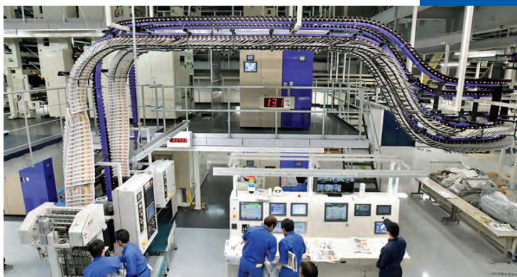
平成28年（2016）、矢巾町に完成した制作センターの輪転機
